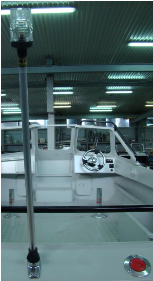
Съемный ходовой огонь в рабочем положении (слева); Заливная горловина топливного бака (справа).
