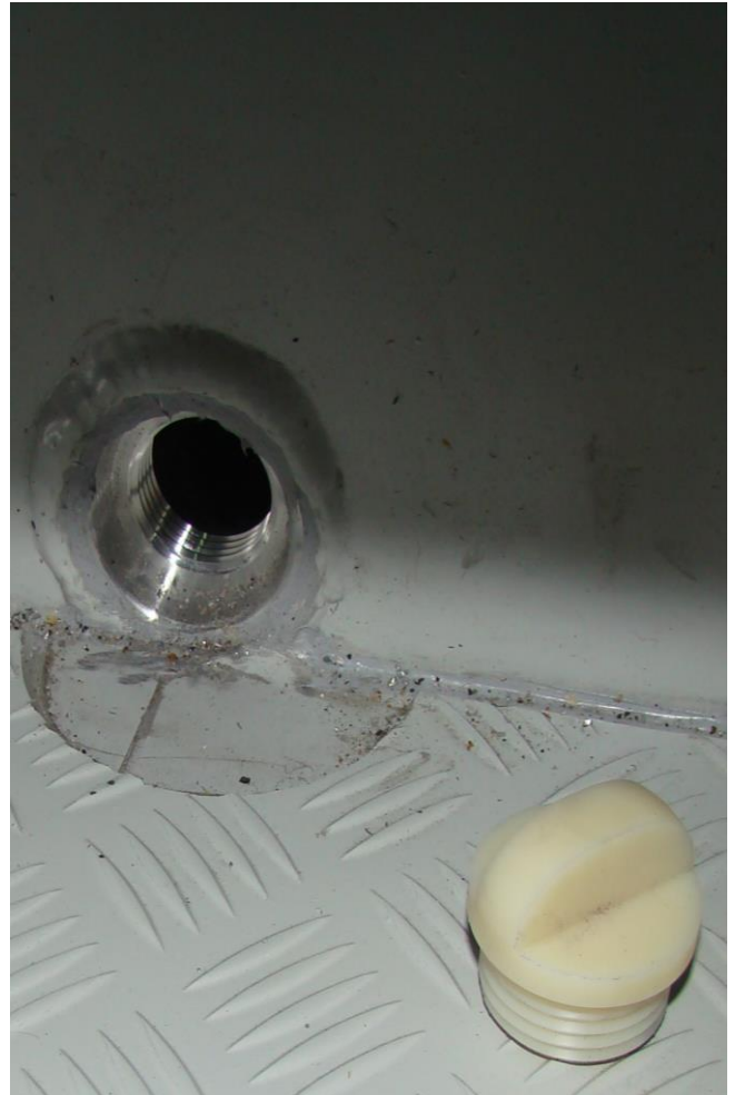
Слив воды с поверхности палубы в открытом положении (закрытое положение при ввернутой пробке).
