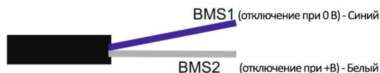
Рисунок 8. Назначение синей и белой жил кабеля управления
