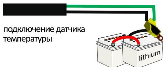
Рисунок 9 Подключение датчика температуры
