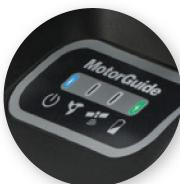
Светодиодные индикаторы отражают состояние четырех основных параметров мотора, включая три уровня заряда аккумулятора.
